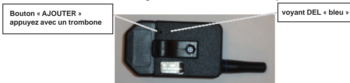
Illustration 2 : Significations des boutons arrière du porte-clé
