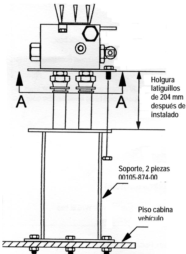
1. **IMPORTANTE:** Se debe aplicar un producto sellante, compatible con el aceite hidráulico a utilizar, en todas las conexiones NPT. (no se recomienda utilizar cinta de teflón).
